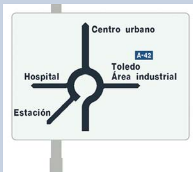
Señalización previa a una glorieta.
