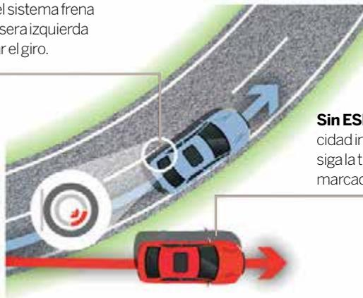
**Sin ESP:** el exceso de velocidad impide que el coche siga la trayectoria curva marcada con la dirección.
