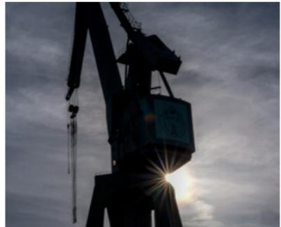
railles con un motor de 65 caballos de vapor y estaba construida uniendo chapas mediante tornillos calentados a 900 grados. Unido a sus 60 metros de altura la hacían única en su especie.
