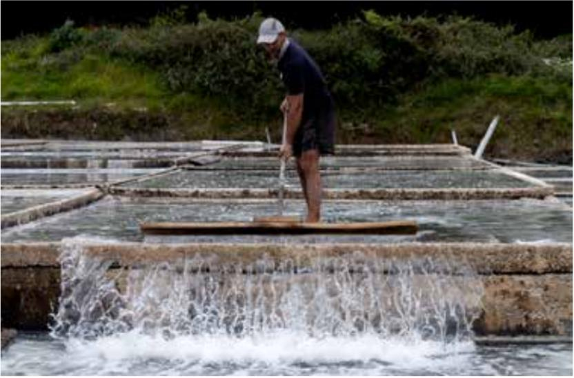
Las Salinas de Oro se caracterizan por la producción artesanal de sol con agua de manantial, proveniente de yacimientos salinos. Este agua se lleva hasta piscinas o eras donde son regadas y se deja reposar hasta que el sol y el aire evaporan el agua y la sal se deposita en el fondo de las piscinas.
